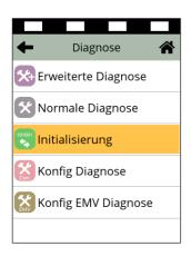
In der Kopfzeile des Displays steht der Name des Menüs, in dem Sie sich gerade befinden, z. B. Menü **Diagnose**. In den folgenden Zeilen sind die Namen der Untermenüs aufgelistet.
