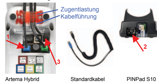
Abbildung 2: Verbindung mit Standardkabel
